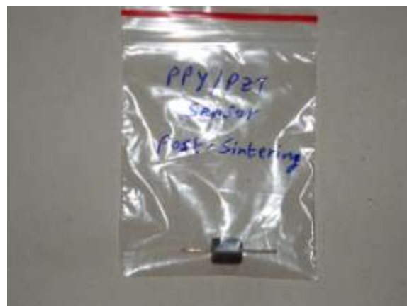
Figure 13: The actual PPy/PZT Sensor
